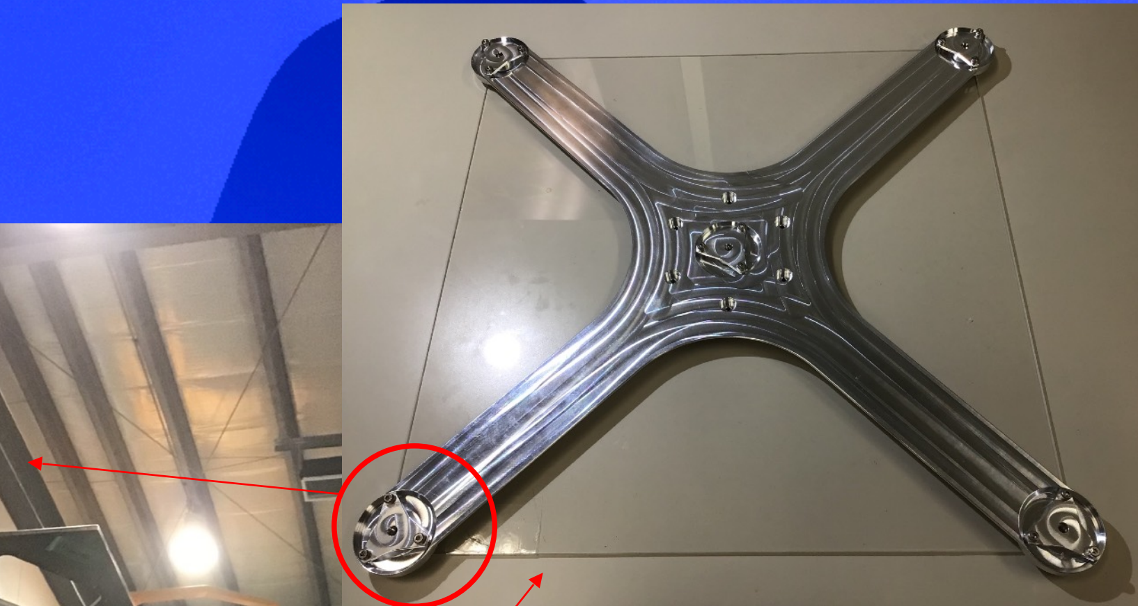
副鏡用レーザー測ステイ <10um (L~400mm)
