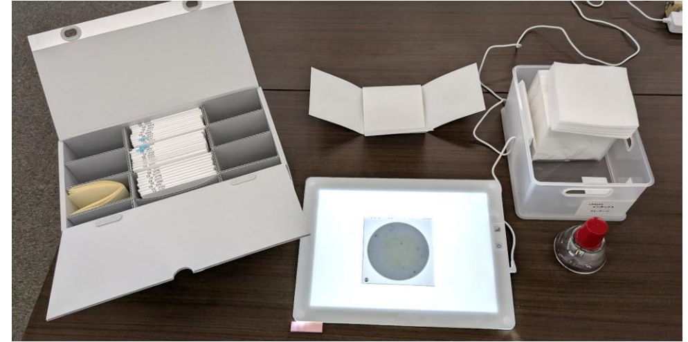
図5: 写真乾板のクリーニングキット。乾板保存容器から取り出 した乾板をLEDビューワに載せ、乾板のガラス面をエタノールを 含めた布で拭った
