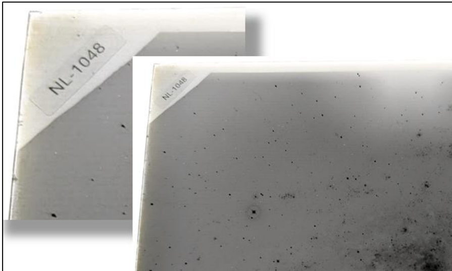
図6: 乾板を区別するために ID シール(4mm×14mm) を用意し貼りつけた。
