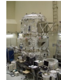
構成パーツ・一部の組立て治具の高真空ベーキング アウトガス測定
